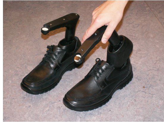
Figuur 9: Plaatsen van de schoenspanners
