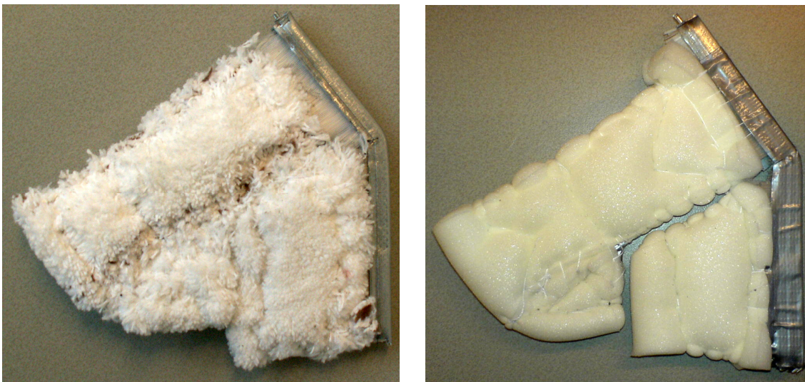
Figuur 22: De non woven borstel en de nieuwe sponsborstel voor de Renaissance test
