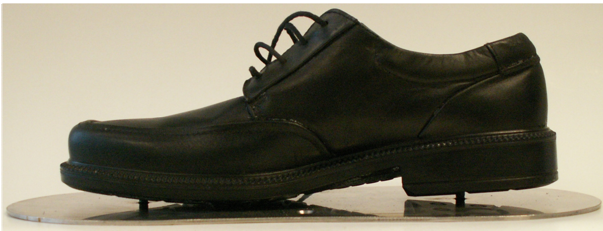
Figuur 20: De nieuwe bodemplaat dat verschuiven van de schoen tijdens het poetsen onmogelijk maakt
