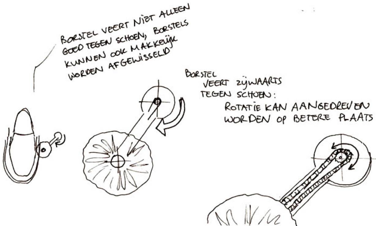
Figuur 49: Principe van zijwaarts verende borstel
